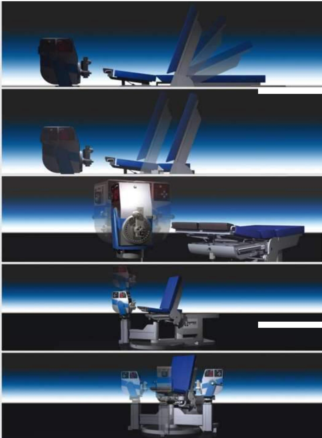
MEMOTRONIC je jedinstveni sustav serije IsoMed 2000. Omogućuje vam da napravite vrlo precizne recidive već spremlijenih položaja ispitanika, da biste dobili trajne i ponovljive rezultate mjerenja - uključujući sve dodatne položaje, kao što su nagib naslona za leđa, pomak naslona, okretanje dinamometra, visina dinamometra ili satelitska ruka mogu se automatski podešiti kroz servo pogon. Ali pogledajte sami što MEMOTRONIC može učiniti za vas!
